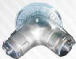
401 Toma siamesa cromada, fabricada en bronce con entradas hembras giratoria de 2 1/2 NST y salida de 4" NPT con tapones y cadena, para colocarse a la red de hidrantes con placa cromada con la leyenda BOMBEROS.
